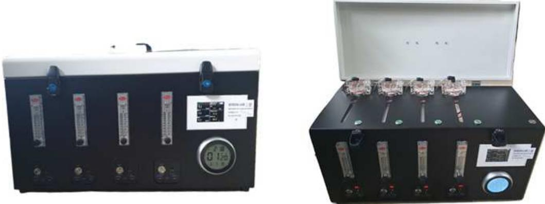
그림 9. 바이오 미세먼지의 크기분포 측정을 위한 4채널 소형 시스템
